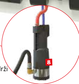
Zpomalovač přítoku do nádrže (zamezuje zápachu vody díky oxysličování)
